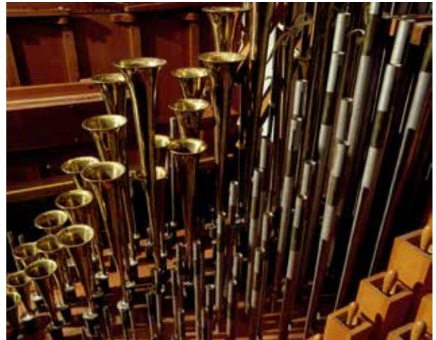
Drei unterschiedliche Pfeifenregister in der Solokammer (v.l.n.r.): 1. Trompeten (Zungenstimmen mit Schallbechern aus Messing) 2. Viol celeste / Viol d'orchestre (schwebend gegeneinander verstimmte Labialpfeifen entsprechend der Vox humana einer Kirchenorgel) 3. Bourdon (gedackte Labialstimmen aus Holz) © MIM, Foto: Knud Peter Petersen
